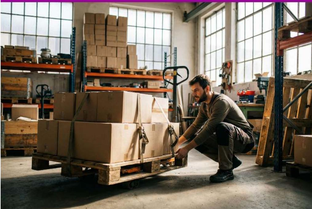
*Utiliser un transpalette pour soulager la charge manuelle au-delà de 30 kg*
